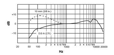
TYPICAL FREQUENCY RESPONSE RÉPONSE EN FRÉQUENCE TYPIQUE TYPISCHER FREQUENZGANG RESPUESTA DE FRECUENCIA TIPICA RISPOSTA IN FREQUENZA TIPICA
