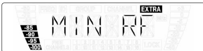
Esempio 2: Livello RF minimo -85 dB.
