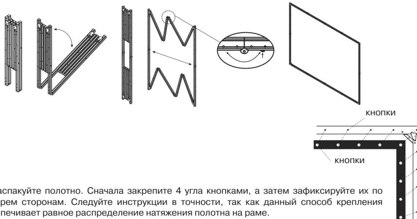
3. Распакуйте полотно. Сначала закрепите 4 угла кнопками, а затем зафиксируйте их по четырем сторонам. Следуйте инструкции в точности, так как данный способ крепления обеспечивает равное распределение натяжения полотна на раме.
